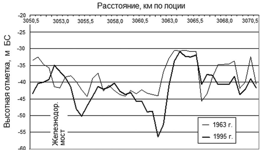
Рис. 3. Вертикальные деформации дна в районе перехода газопровода Ермолинское — Промысловое — Астрахань через дельтовый рукав Волга по трассе судового хода за 1963–1995 гг. (БС — Балтийская система высот)
